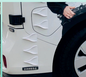
De små hajfiner sparer CO 2 , fordi de mindsker vindmodstanden
