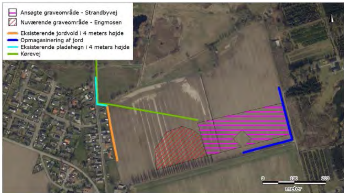
Figur 7: Markering af kørevej (grøn streg), eksisterende jordvold i 4 meters højde (orange streg), samt eksisterende pladehegn i 4 meters højde (lyseblå streg). Arbejdsområdets placering er markeret som en rød flade. Blå streg markerer opmagasinering af jord, der udlægges som en midlertidig jordvold på 2,5 m.
