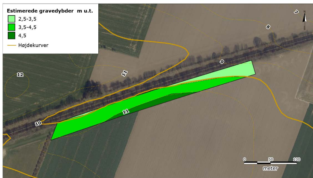
Figur 2: Estimere gravedybder som illustration af terrænet hvis der ikke fyldes op
