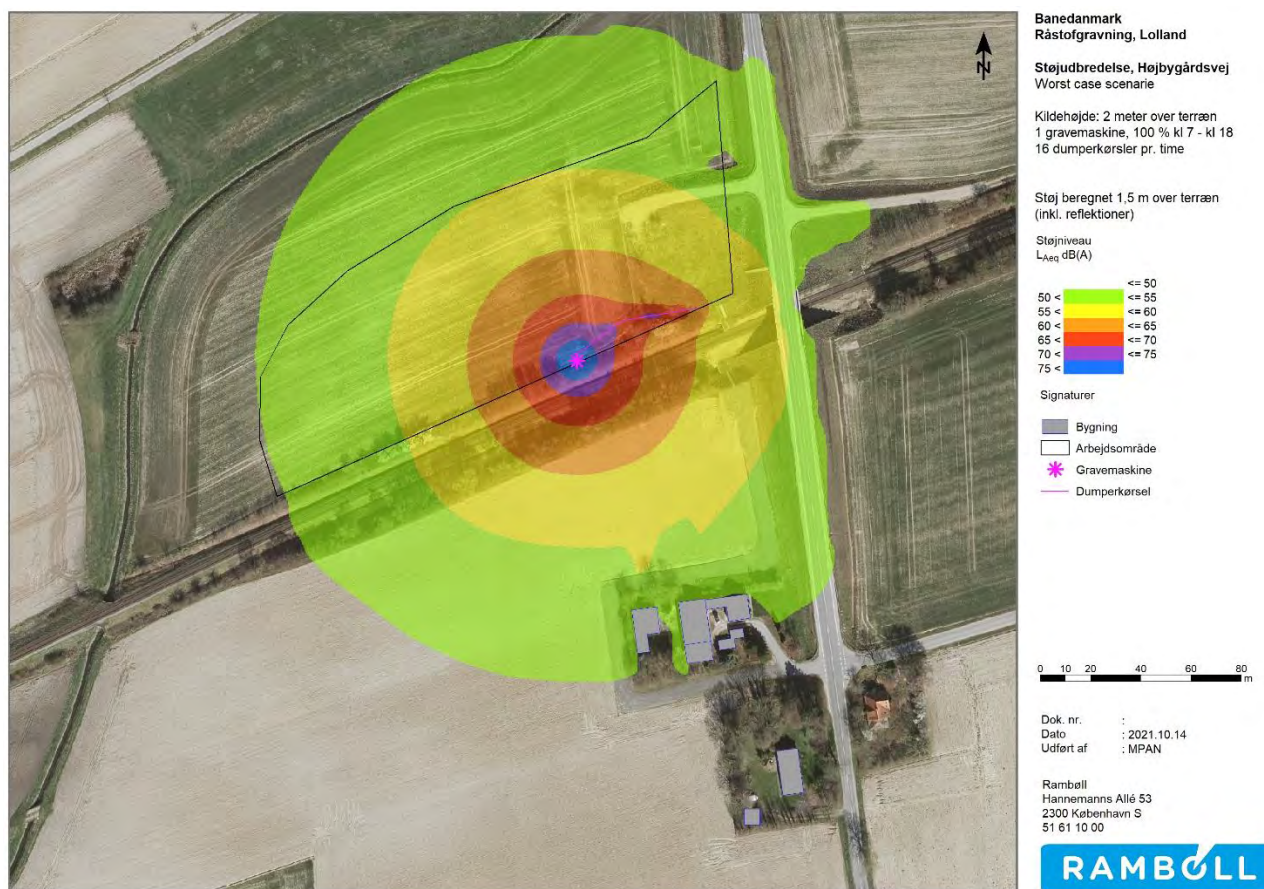
Figur 2 Driftsfase. Gravemaskine placeret tættest muligt boliger uden støjafskærmning. På denne afstand til boliger kan arbejdet udføres uden overskridelse af grænseværdien på 55 dB.
