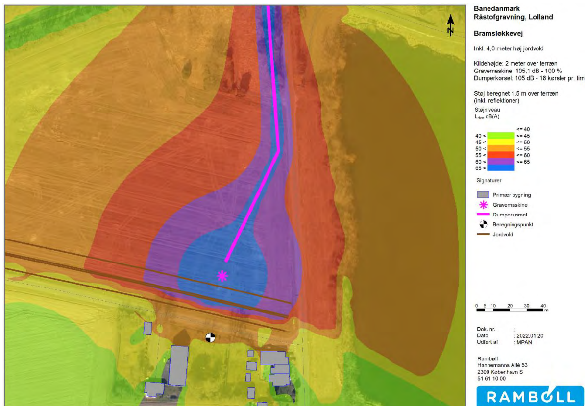
Figur 3 Støjuddbredelse under forudsætning af etablering af 4,0 meter høj støjvold i udgravningens sydlige ende. Gravemaskinen placeret tæt på nærliggende boliger. På denne afstand kan arbejdet ikke udføres uden at overskride grænseværdien.
