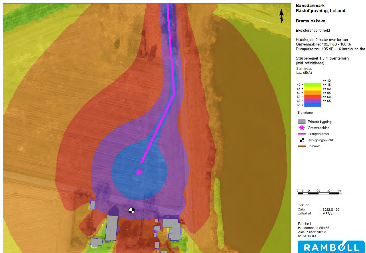
Figur 2 Støjudbredelse ved eksisterende forhold i udgravningens sydlige ende. Gravemaskinen placeret tæt på nærliggende boliger. På denne afstand kan arbejdet ikke udføres uden at overskride grænseværdien.
