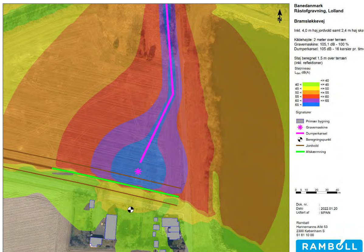
Figur 4 Støjuddbredelse under forudsætning af etablering af 4,0 meter høj støjvold samt 2,4 meter høj støjskærm i udgravningens sydlige ende. Gravemaskinen placeret tæt på nærliggende boliger. På denne afstand er det muligt at udføre arbejdet uden at overskride grænseværdien.
