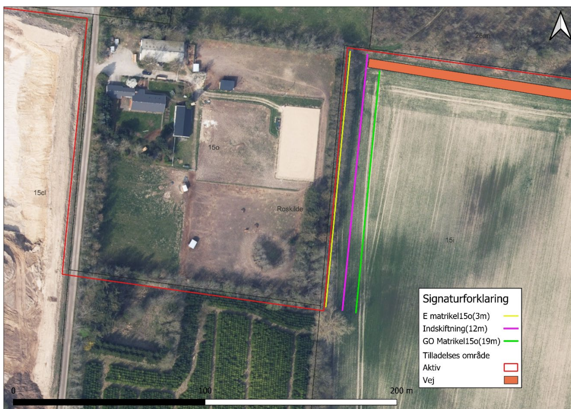
Figur 1 Kortet angiver gravegrænser på matrikel 15i ind mod matrikel 15o. Den gule streg angiver efterbehandlingsgrænsen (e). Den grønne streg angiver gravegrænsen (GO) og den lilla streg angiver hvortil indskiftningen må ske. Kortet er en skitse.
