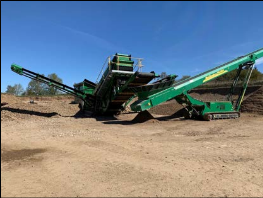
Foto 7: Sorteringsanlæg og transportbånd (Lokation D)
