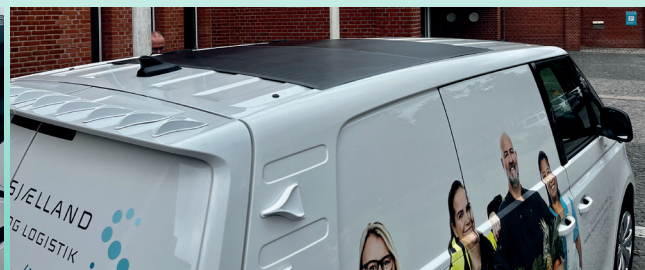
VW Buzz'en der kører for RS Lager og Transport, har solfanger på taget, som genererer el til bilen
