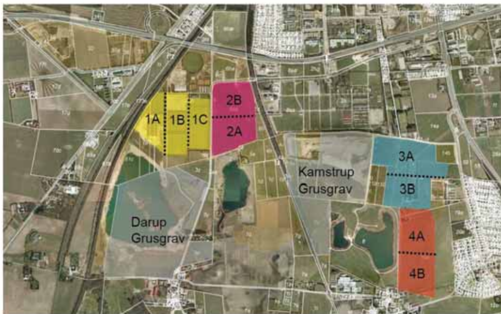
Rækkefølge for udgravning 1A påbegyndes tidligst i 2013 og 1B tidligst i 2015 Herefter følger 1C-2A-2B-3A-3B-4A og 4B i nævnte rækkefølge
