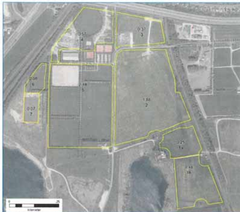
Figur 1.1 Vurdering af sand-/grusmængder (mio. m 3 ) i de 7 delområder udført af Nymølle Stenindustrier.
