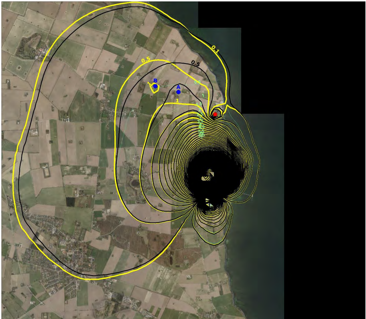
Figur 4.3. Visualisering af sænkning ved slutningen af Graveperiode 2, når der infiltreres op til 12 m 3 /time, set som helhed over hele området. Samme signatur som i Figur 4.2.
