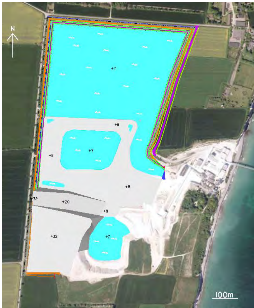
Fig. 13: Slutsituation, dersom bruddriften stopper efter at det ansøgte området er færdig brudt. Alle søer (blå farve) vil blive i kote +7m. Landområdene vil få ulige højder, fra kote +32m i syd til kote +8m i nord.
