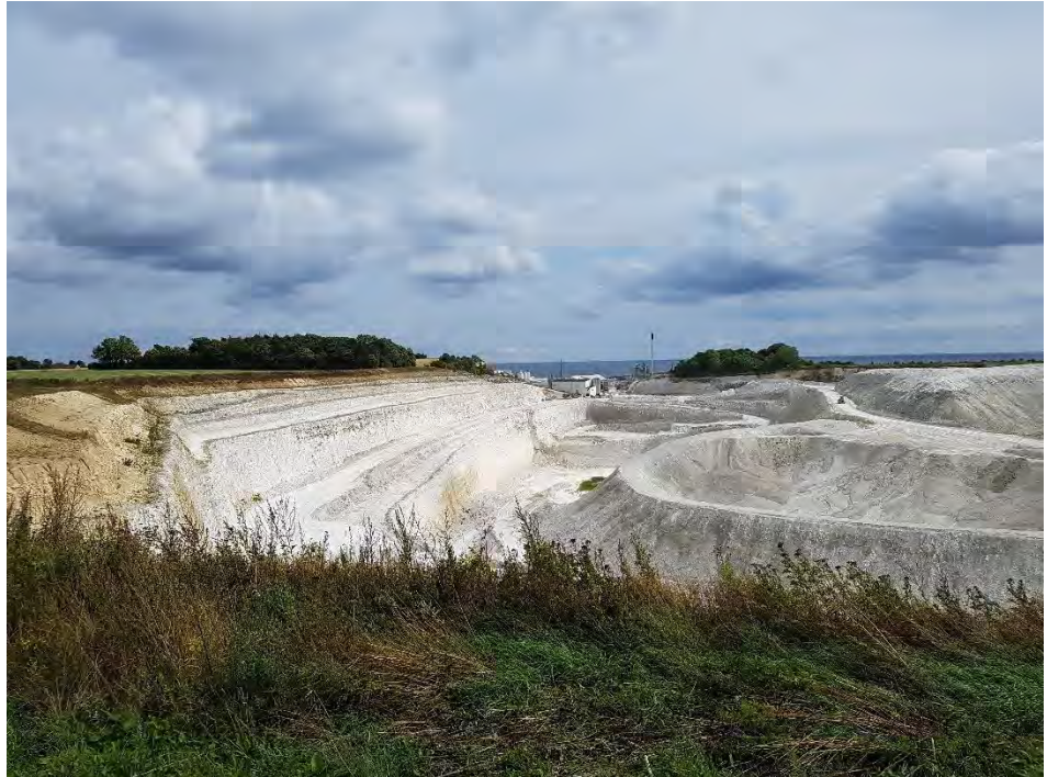
Figur 3.2: Udsigt over det eksisterende kridtbrud med overjord af muld og istidsaflejringer øverst. Derunder ses den ikke brugbare kalk/ gråkridt. Den samlede tykkelse af disse lag forventes at være 10 – 30 m.
