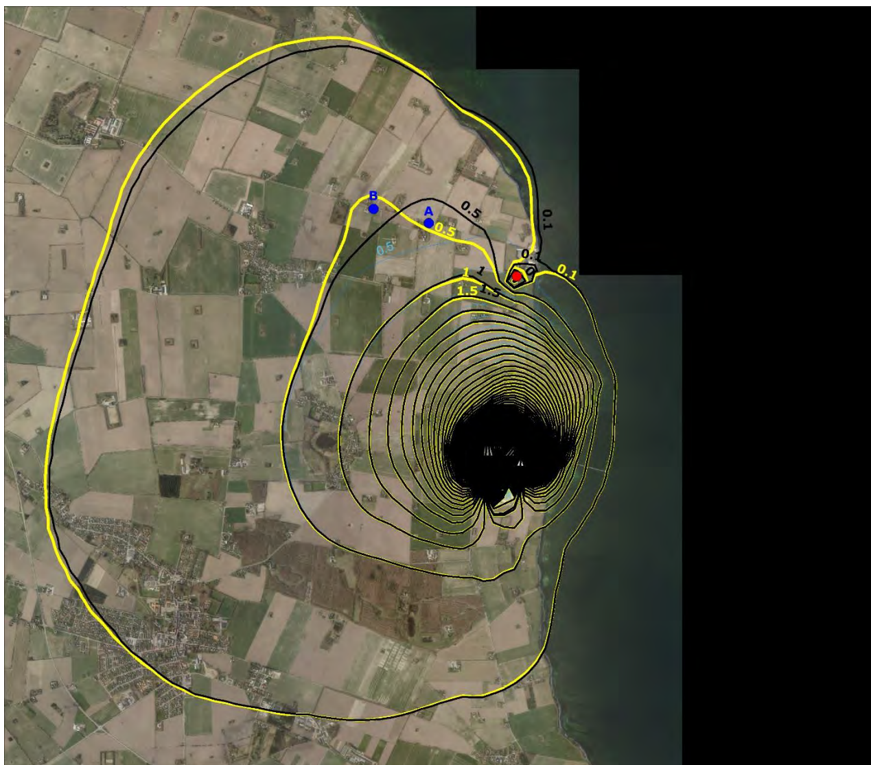
Figur 3.3. Visualisering af sænkning ved slutningen af Graveperiode 1, når der infiltreres op til 5,5 \text{ m}^3/\text{time} , set som helhed over hele området. Samme signatur som i Figur 3.2.
