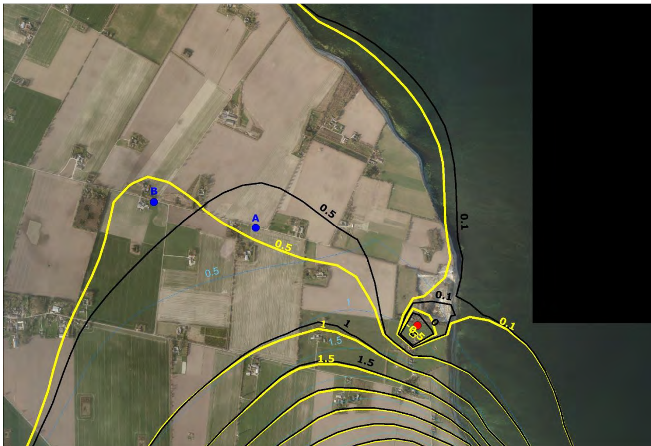
Figur 1. Visualisering af sænkning ved slutningen af Graveperiode 1, når der infiltreres op til 5,5 m 3 /time. Sort linje: Sænkning når der sker oppumpning ved pumpeboring A. Gul linje: Sænkning når der sker oppumpning ved pumpeboring B. Tynd blå linje: Sænkning i det oprindelige scenarium uden infiltration. Infiltrationsboringen er beliggende ved den røde cirkel. Fra /4/.
