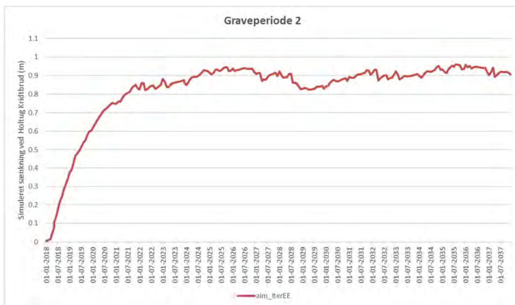
Figur 3.3 Simuleringer af sænkning i Holtug Kridtbrud i Graveperiode 2 ved gravning til fuld dybde jf. kortet i Figur 2.2 (største dybde kote -28 m).
