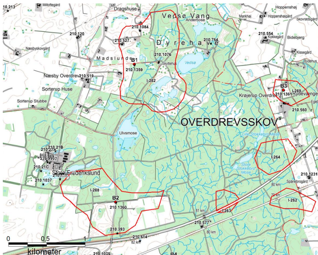
Figur 7.1 De nye råstofboringer fremgår af figuren med en rød cirkel samt borings nr. og DGU nr. Eksisterende Jupiterboringer ses ved sort stjerne og DGU nr.
