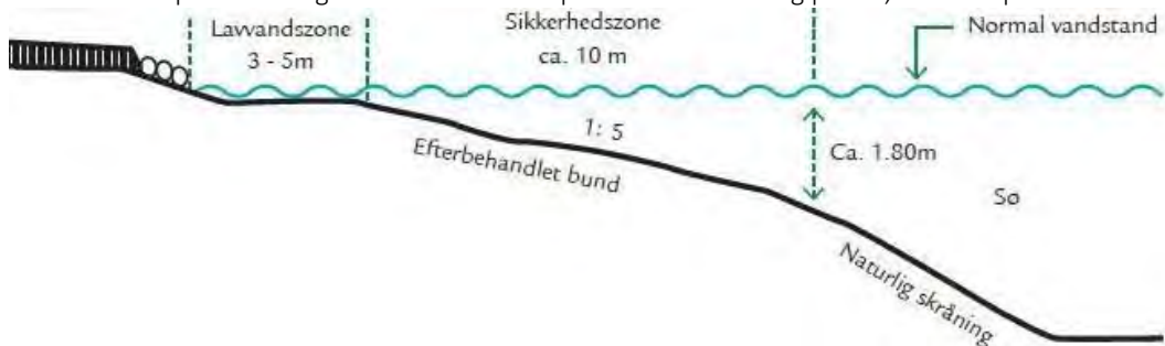
Figur 1 - Principskitse for efterbehandling af gravesø
