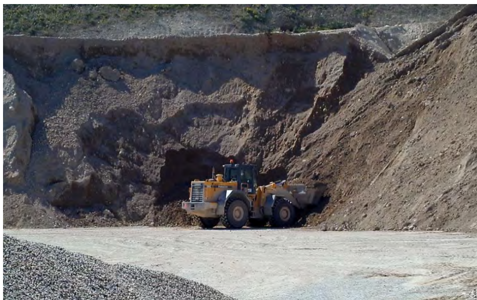
Figur 4.3: Indvinding af materialer over grundvandspejl med læssemaskine.
