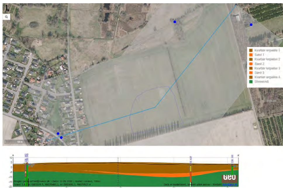
Figur 3-4: SV-NØ gående profil gennem det ansøgte areal. SV er til venstre på figuren. Det ansøgte areal er ved den stiplede linje på profilet.
