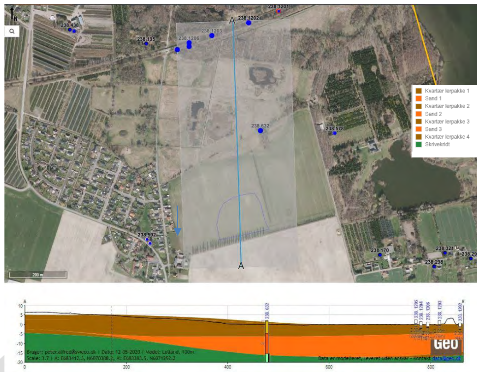
Figur 3-3: SN geologisk profil gennem det ansøgte areal. Syd er til venstre på profilet.
