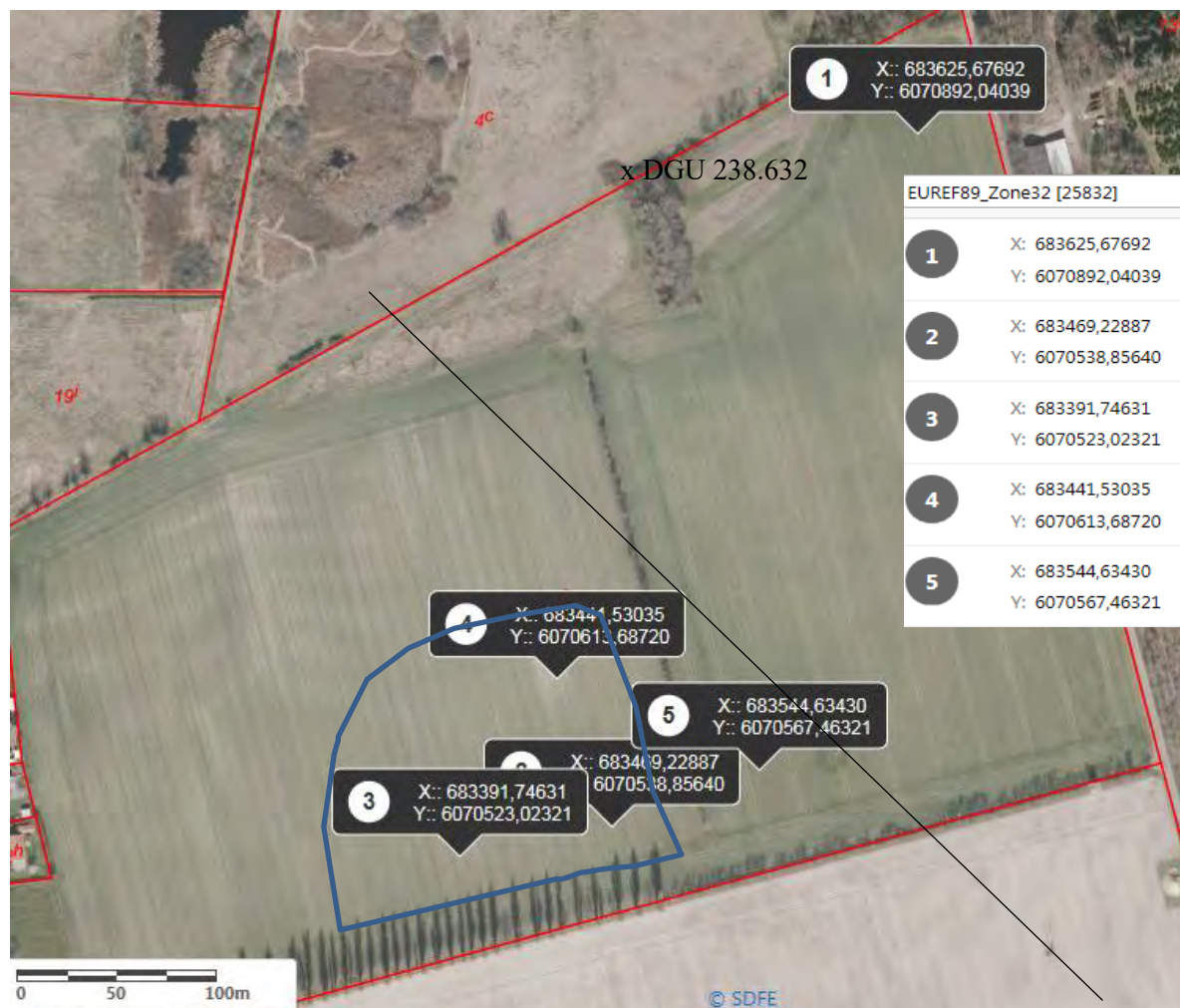
Figur 1: Prøvegravning, PG1-PG5 samt markering af højspændingsledning (Sort streg) på området og markvandindvindingsboring DGU 238.632. Blå område forslag til Sidetagsområde.
