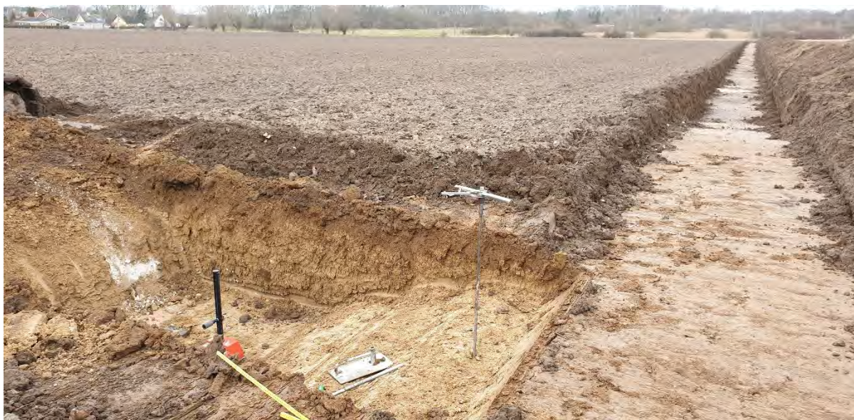
Foto3: Prøvegravning, PG4 ved søgerende. Moræneler over sandlag
