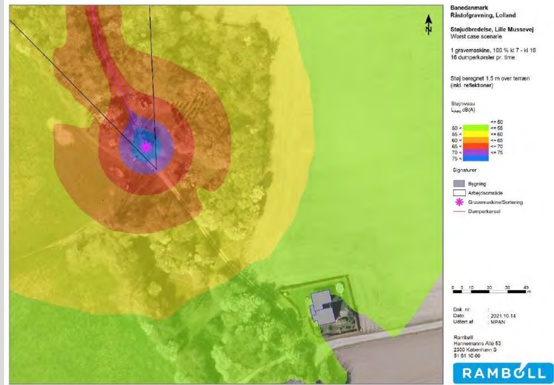
Figur D: Driftsfase ved Ejendommen Stilund 2. Gravemaskine placeret 110 meter fra bolig uden støjafskærmning. På denne afstand til boliger kan arbejdet udføres uden overskridelse af grænseværdien på 55 dB.
