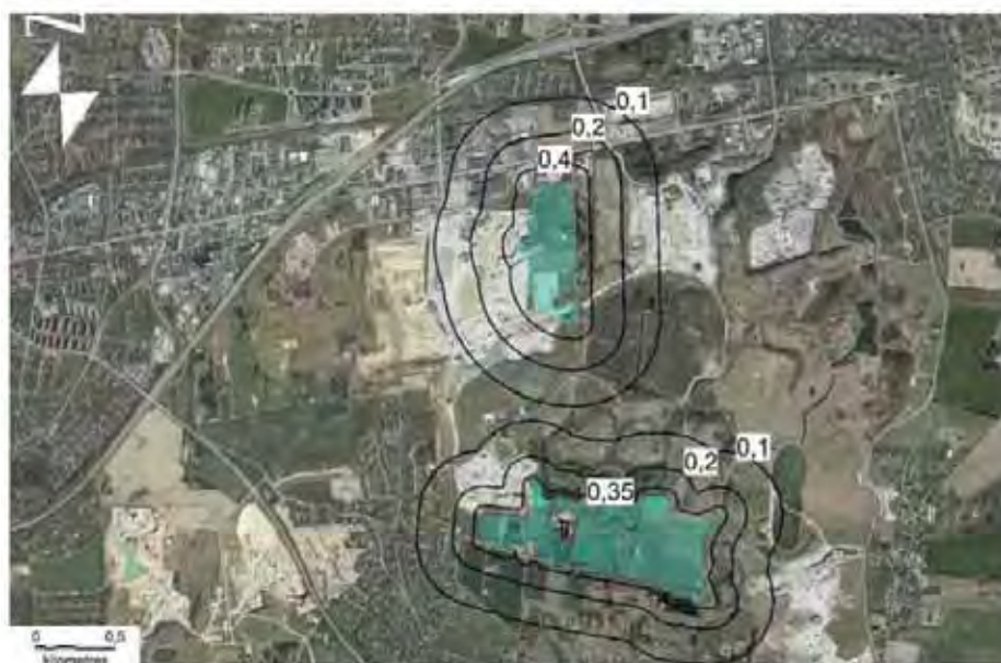
Figur 7-4: Illustration af teoretisk beregnede sænkningstragte i Hødeland-formationen fra samtidig gravning under grundvandsspejlet i begge delområder. Sænkningen er vist på et fladt grundvandsspejl og angivet i meter.
