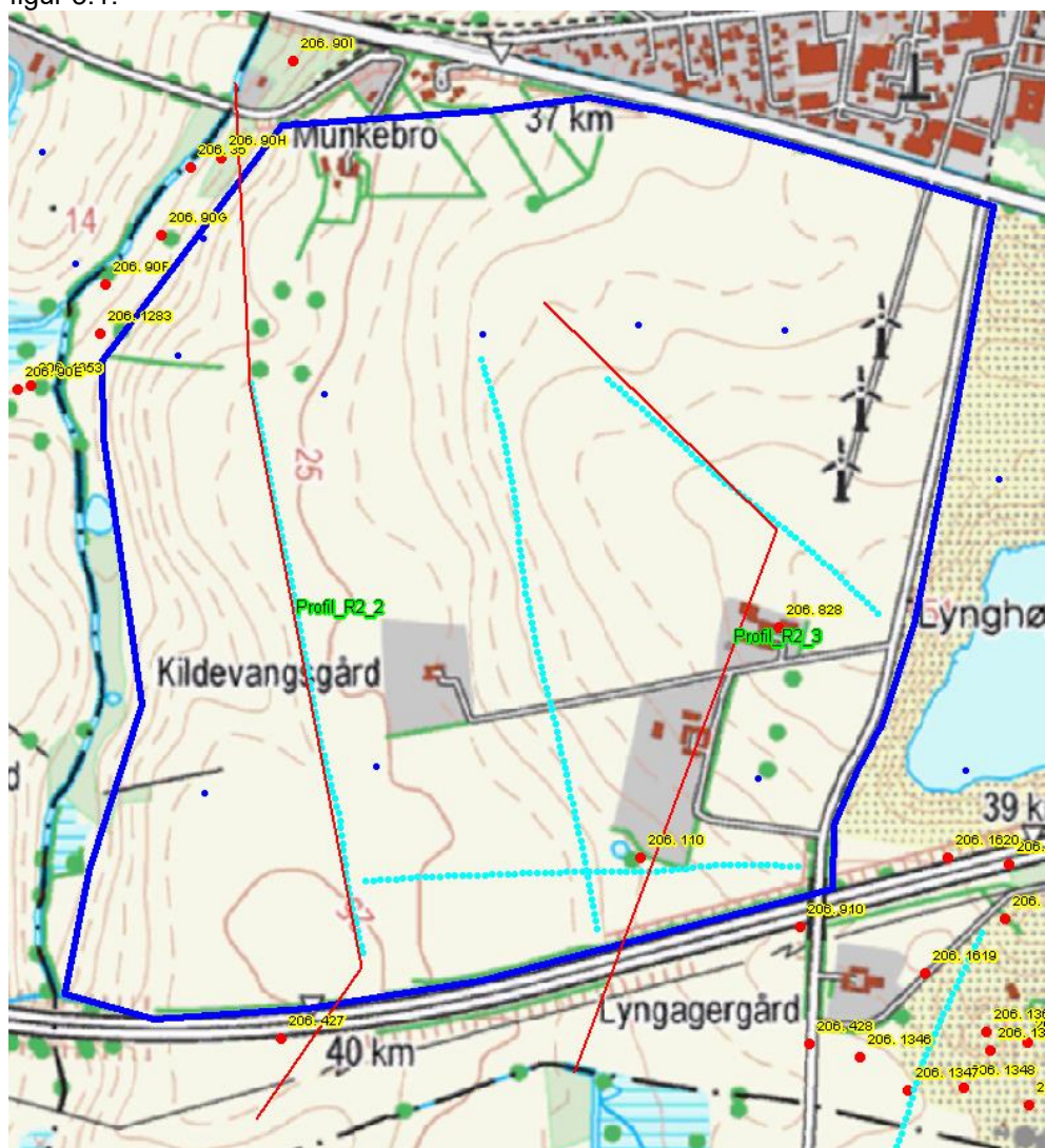
Figur 3.1. Kortlægningsområde I-239, angivet med blå stregfarve. Geofysiske MEP data (lyseblå prikker), TEM (mørkeblå prikker). Boringer med DGU nr. (rød prik). Profillinjerne fremgår af kortet med rød stregfarve.
