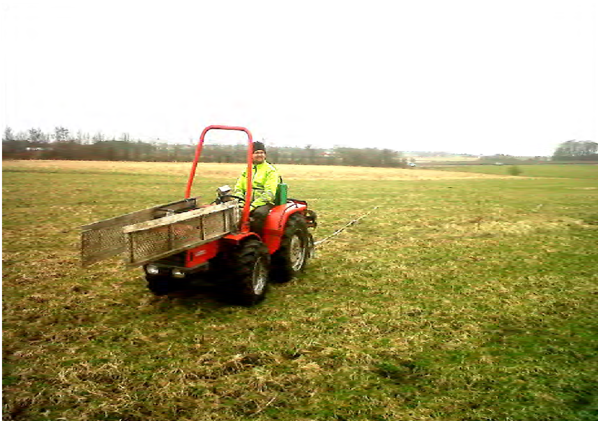
Figur 3.1: Det slæbegeoelektriske måleinstrument. Traktoren slæber elektrodeslæbet hen over jorden samtidig med, at der sendes strøm ud ved strømelektroderne (sorte). Spændingen måles samtidig hermed på alle spændingselektroder.
