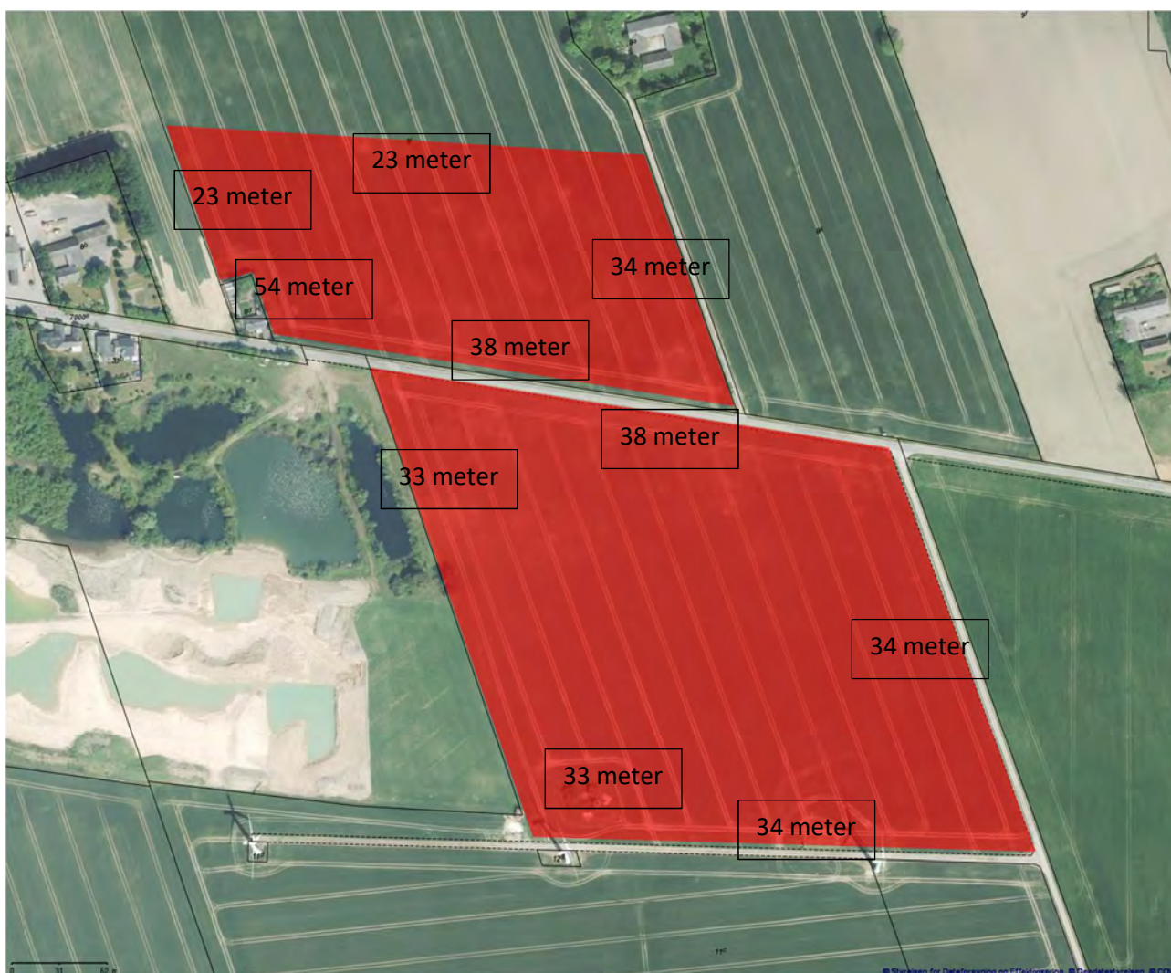
Figur 2: Graveafstandene ved gravning under grundvandsspejl
