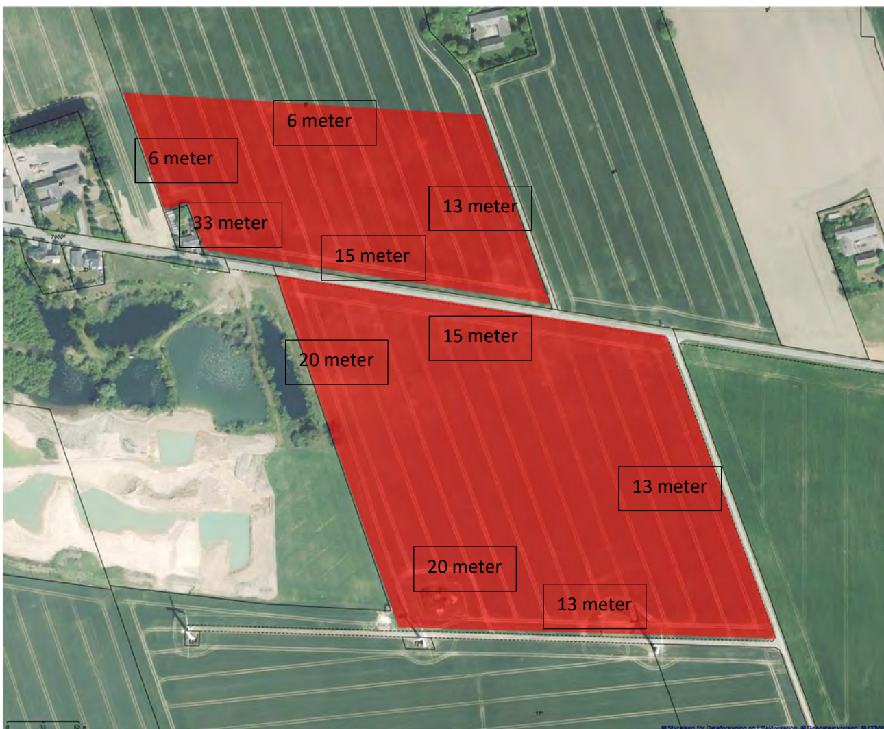
Figur 1: Graveafstandene ved gravning over grundvandsspejl
