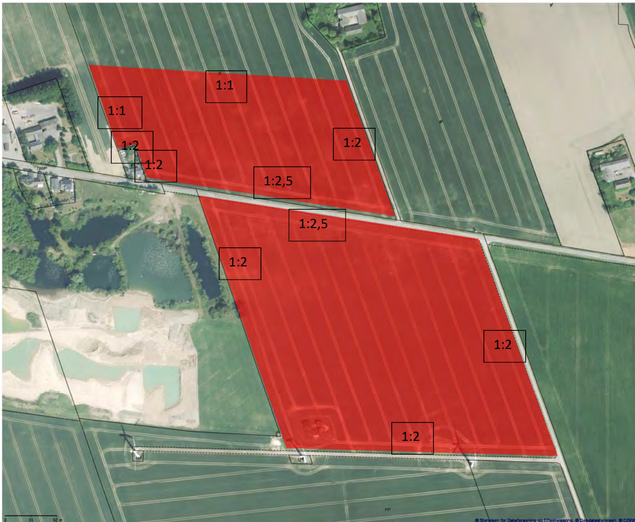
Figur 3: Mindst tilladte efterbehandlede skråningshældninger.
