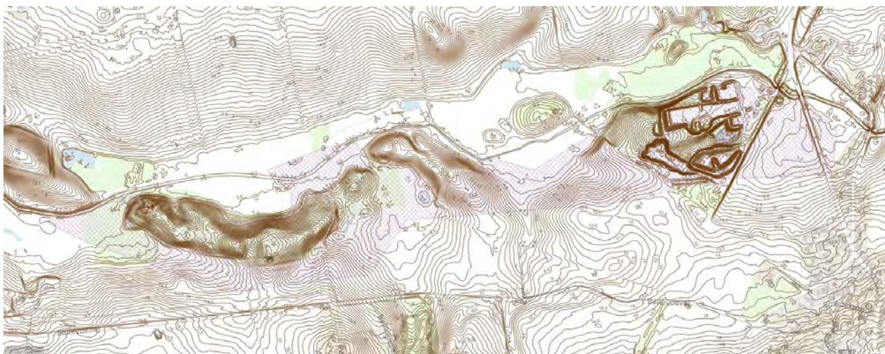
Figur 2.1 Terrænkoter med ækvidistance 0,5 m. Det ses tydeligt, at der tidligere er gravet i den østlige del af I-348. Udtræk fra GeoAtlas. Interesseområderne er skraveret med lilla polygon.
