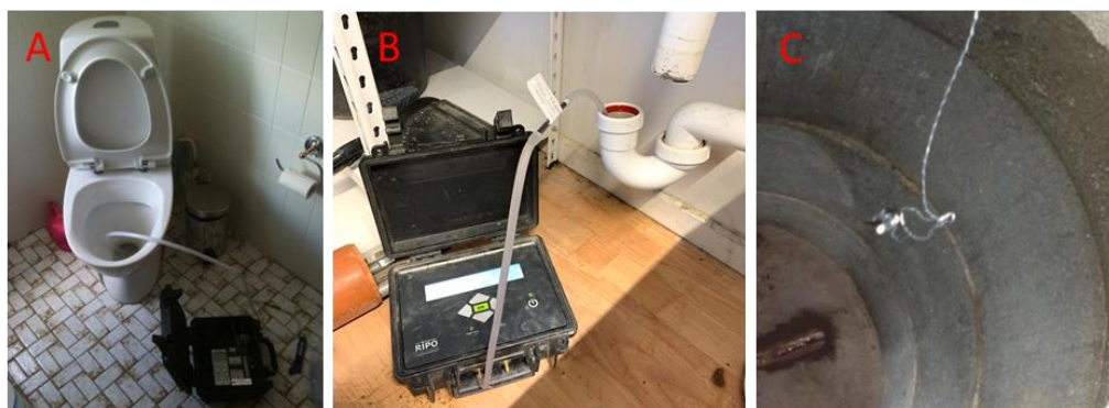
Figur 4.9 Fotos af prøver udtaget i kloaksystemet: A) bag vandlås i toilet, B) bag vandlås under vask og C) i samlebrønd.
