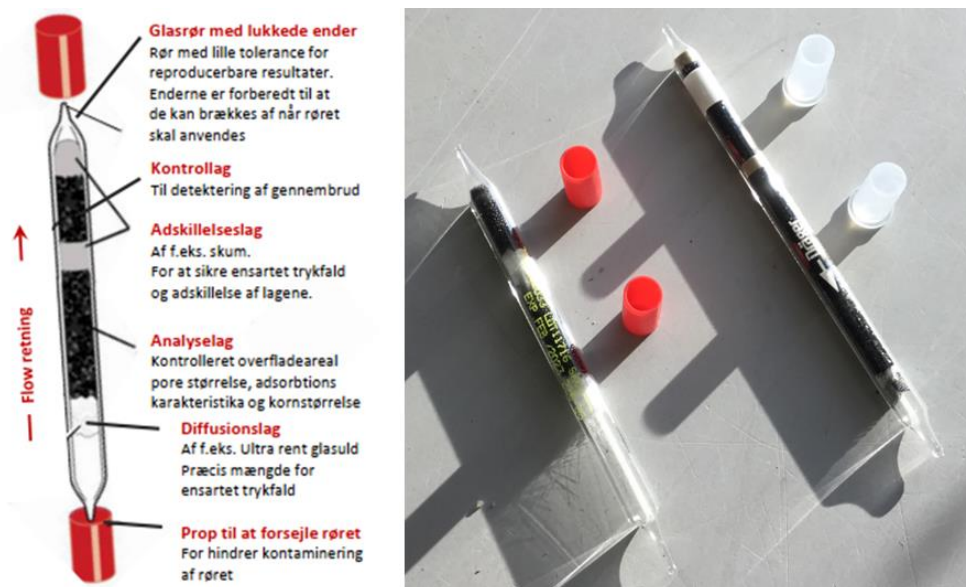
Figur 4.2 Principskitse /21/ og fotos af adsorptionsrør til aktiv prøvetagning.
