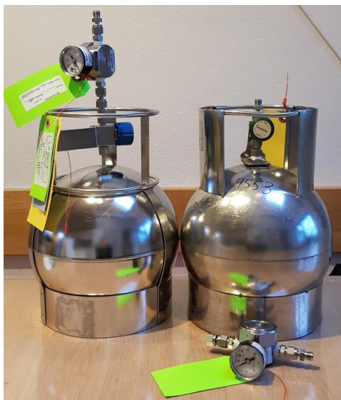
Figur 4.7 Canister hhv. med og uden påmonteret flowventil.
