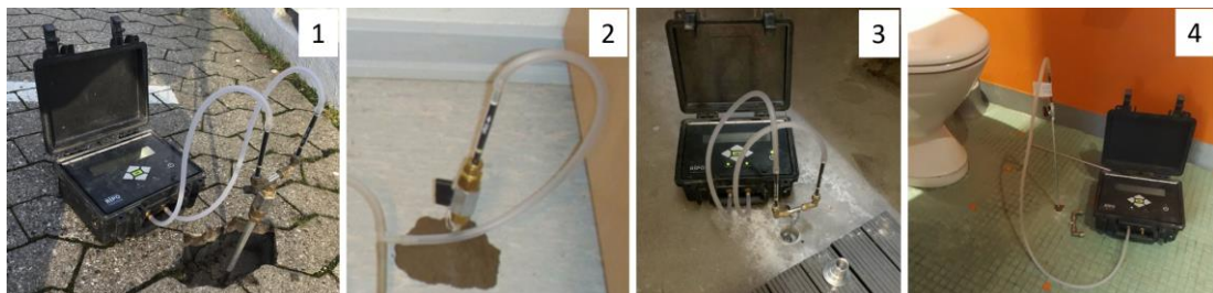
Figur 6.3 Prøveopstillinger til aktiv prøvetagning af poreluft (1) med poreluftspyd, (2) med studs, (3) med VaporPin® og (4) med spyd under muligt utæt gulv.
