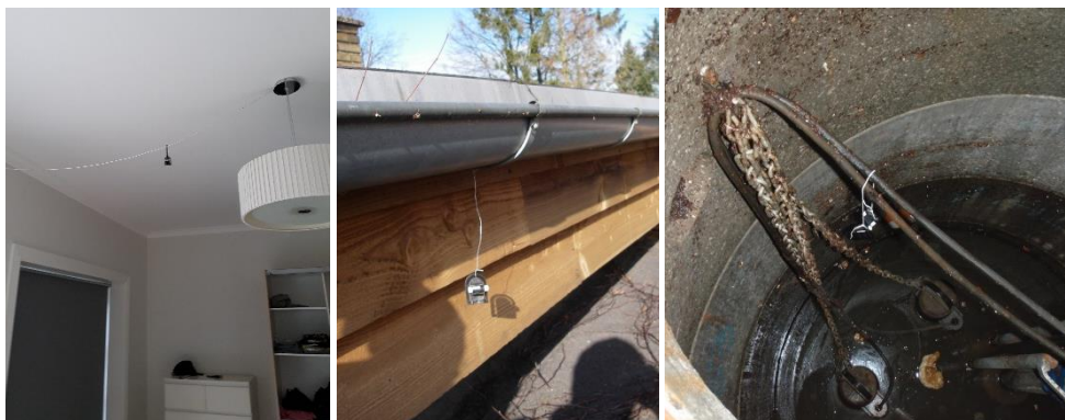
Figur 6.8 Passiv opsamling på ORSA-rør i A) indeluft, B) Udereference og C) Pumpebrønd.
