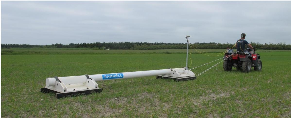
Figur 2 Det anvendte DUALEM-setup.
