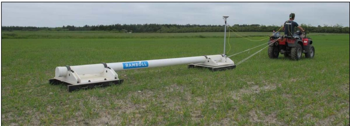
Figur 2 Instrument setup, placeret på en slæde som trækkes bag en ATV.
