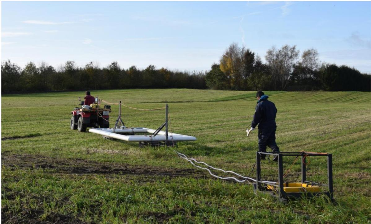
Figur 3 Det anvendte tTEM-setup.
