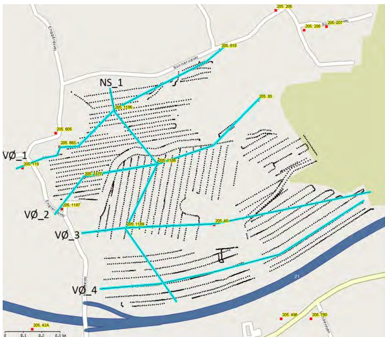
Figur 5.3. Lokalisering af profilerne på figur 5.1 og 5.2 til illustration af overjords- og råstoftykkelse på figur 5.1 og 5.2. Både Jupiterboringer og råstofboringer vises med rød firkant. Korresponderende lokale boringsnumre til DGU numre fremgår af bl.a. tabel 4.1.
