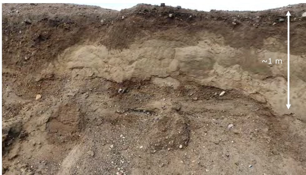
Figur 7: Lag af gruset og stenet mellem-grovkornet sand.
