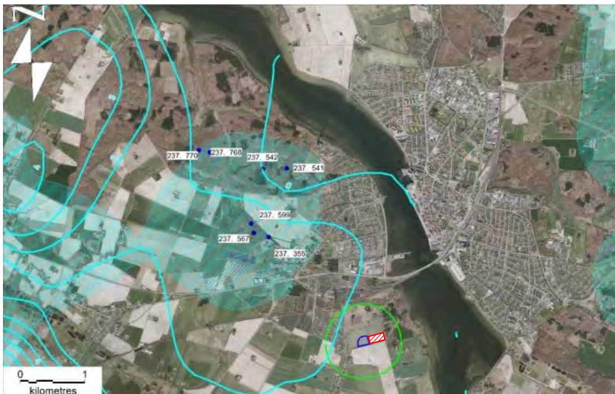
Figur 3-7: Oversigtskort med placering af nærmest beliggende aktive boringer til almen vandforsyning, tilhørende Vandforsyningen Østlolland. Boringerne ligger > 2 km fra det ansøgte areal. Potentialelinjer for det primære magasin vist med lys blå streg, tilhørende indvindingsopland vist med blå skravering. Det ansøgte areal er vist ved rød skravering og det tilstødende graveområde Engmosen er vist med mørkeblå streg, omkranset af en 500 m bufferzone, markeret med grøn streg. Datakilde MiljøGis.
