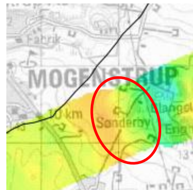
Figur 3.2c. Udsnit af middel-resistivitetskort i I-176-1, dybde 10-15 m u.t.
