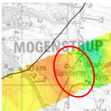
Figur 3.2d. Udsnit af middel-resistivitetskort i I-176-1, dybde 15-20 m u.t.
