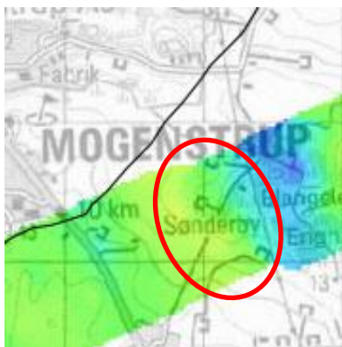
Figur 3.2a. Udsnit af middel-resistivitetskort i I-176-1, dybde 0-5 m u.t.
