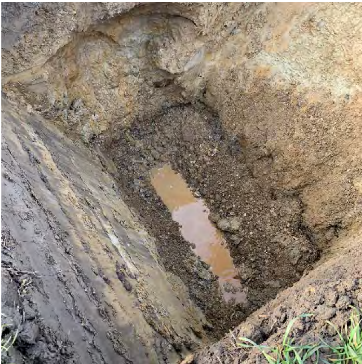
Figur 2-4: Prøvegravning fra den nordlige del af område 2, hvor der ses grundvand i bunden af hullet og grusaflejringer.
