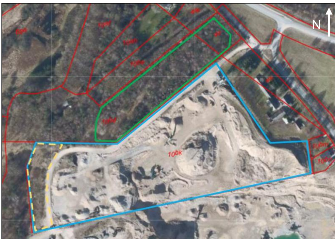
Figur 1 – Graveområder for Sorø Grusgrav. Blå polygon: graveområde i gældende gravetilladelse. Grøn Polygon: udvidet graveområde. Gul polygon: område for harpning af muld.
