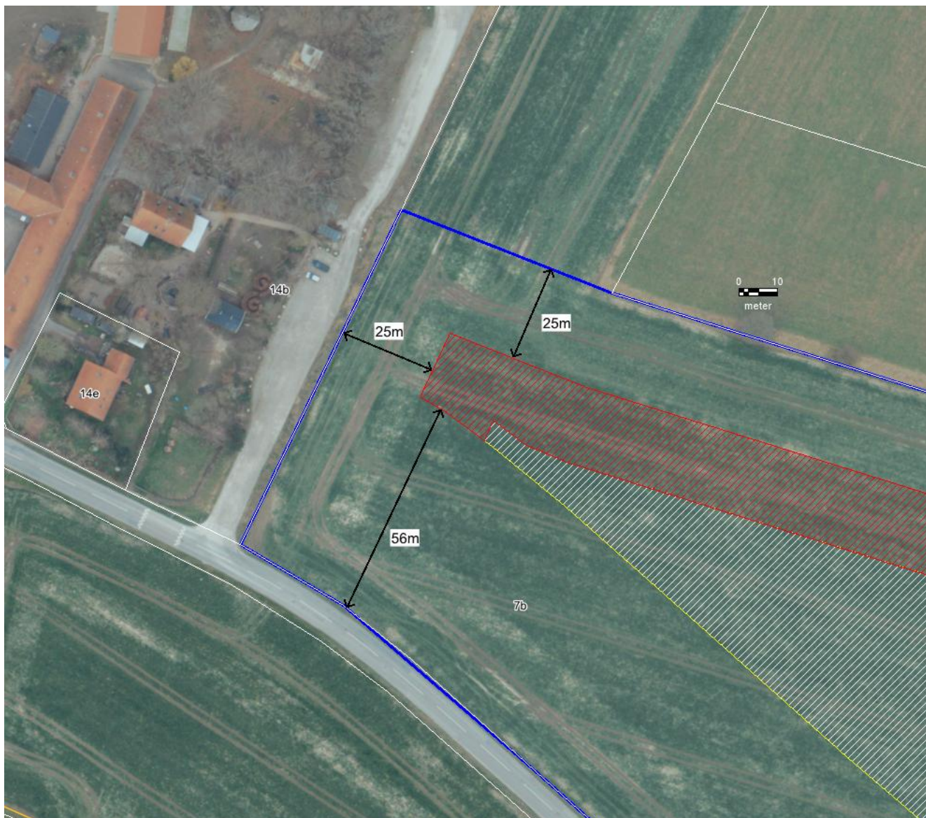
Figur 1. Kort som viser indvindingsområde omfattet af gældende gravegrænser (gul skravering) og areal omfattet af indskiftning (rød).
