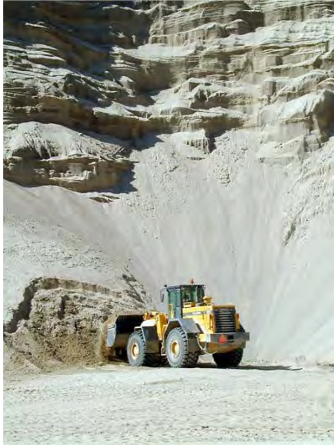
Figur 3.3.19: Gummihjulslæsser – gravning ved gravefront.
