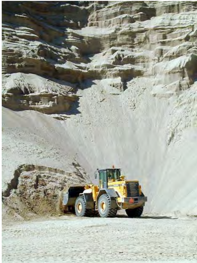
Figur 3.3.19: Gummihjulslæsser – gravning ved gravefront.
