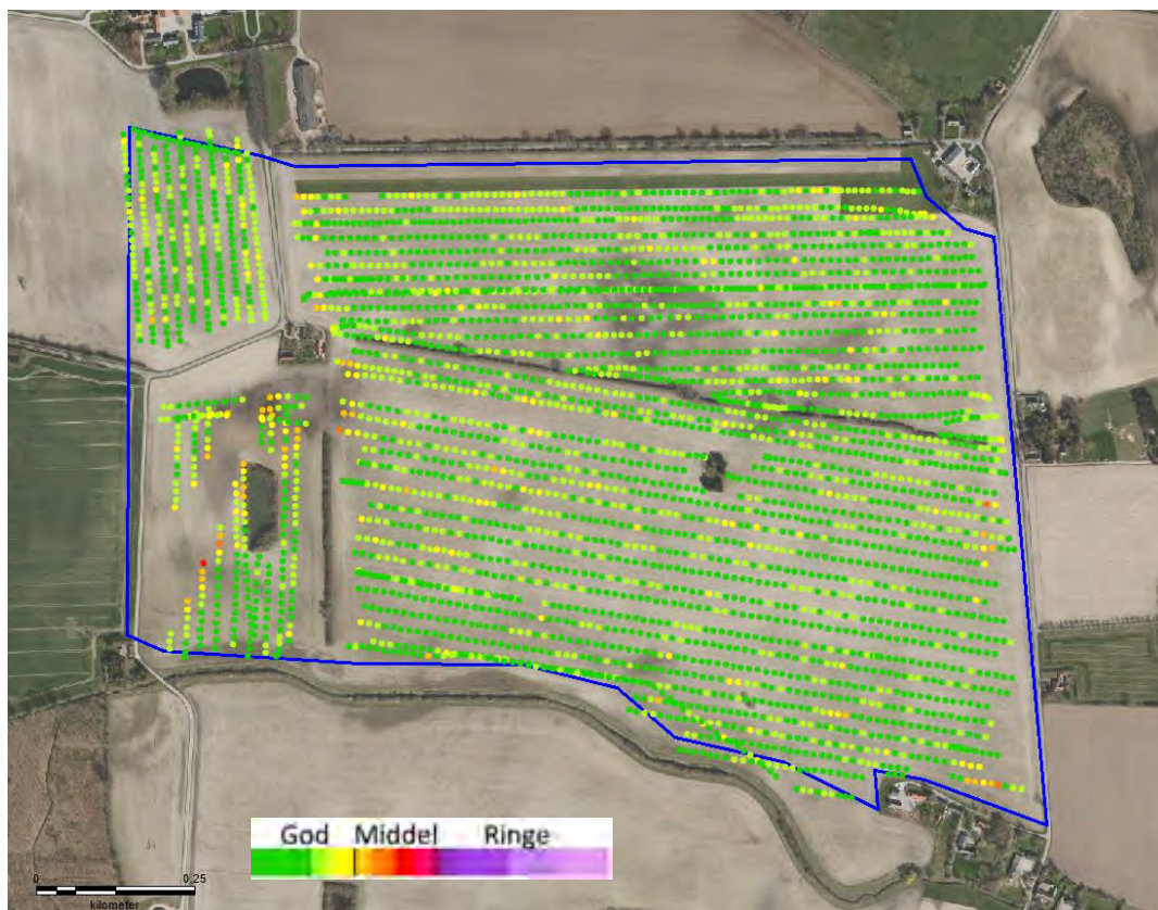
Figur 4.1. Datadækning og dataresidual ved Turebyholm (inversion med løse bånd). Grønne farver viser god datakvalitet, mens gule, orange og røde farver angiver gradvis dårligere kvalitet.
