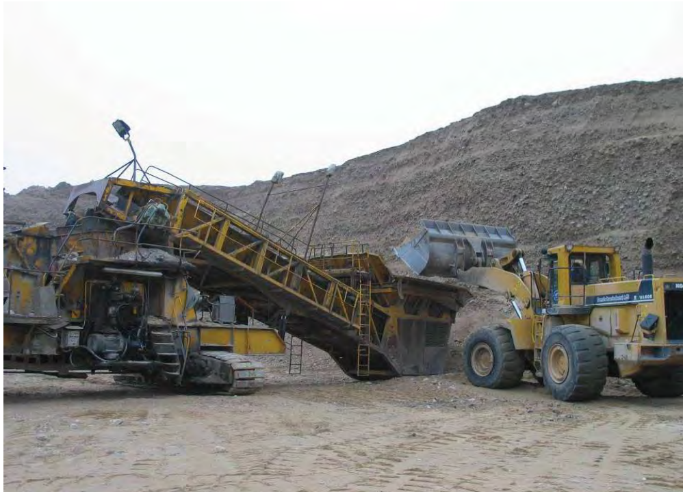
Figur 5.11 Gummiged læsser råstofferne over i en mobil fødekasse med indbygget forknuser, så de kan transporteres på bånd.
