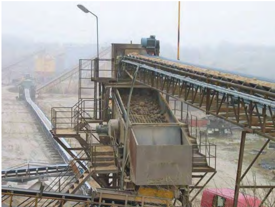
Figur 5.12 Råstofferne transporteres fra gravefront til produktionsområdet på transportbånd.
