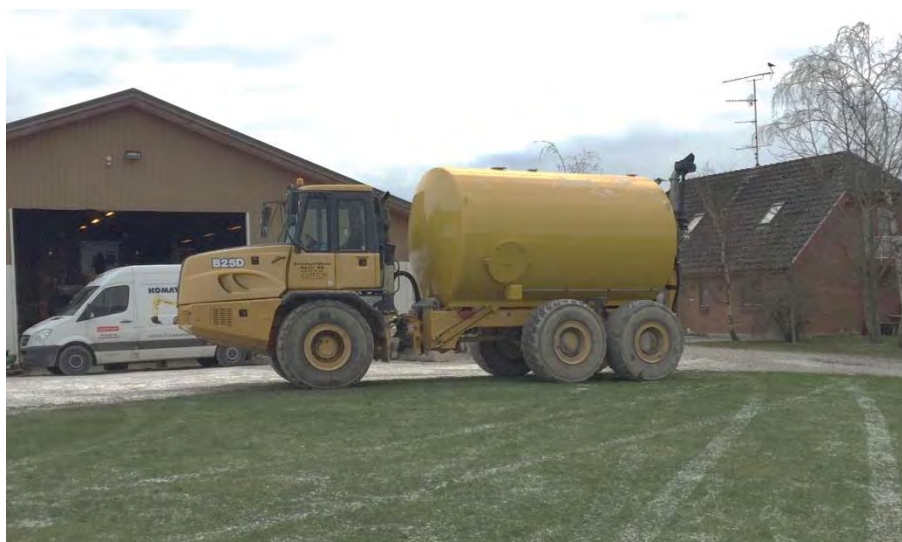
Figur 11.1: Ombygget Bell B25D-dumber som vandvogn.
