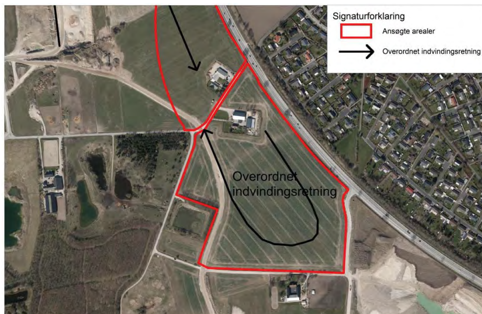
Figur 4.9: Graveretning på det ansøgte areal mod øst, syd for Søbjergvej.
