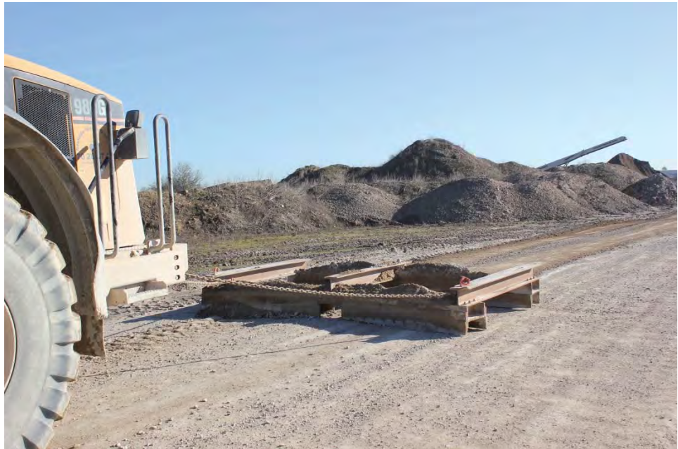
Figur 5.4: Vejhøvl spændt bag frontlæsser til vedligehold af interne køreveje.
