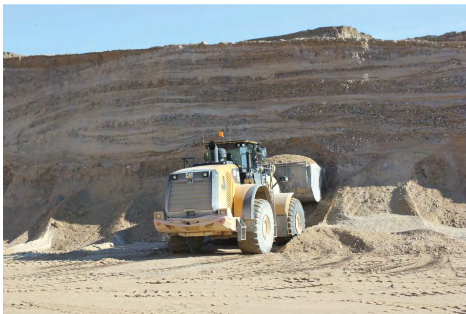
Figur 4.10: Indvindingen over grundvandsspejl sker oftest med en frontlæsser fra foden af gravefronten.
