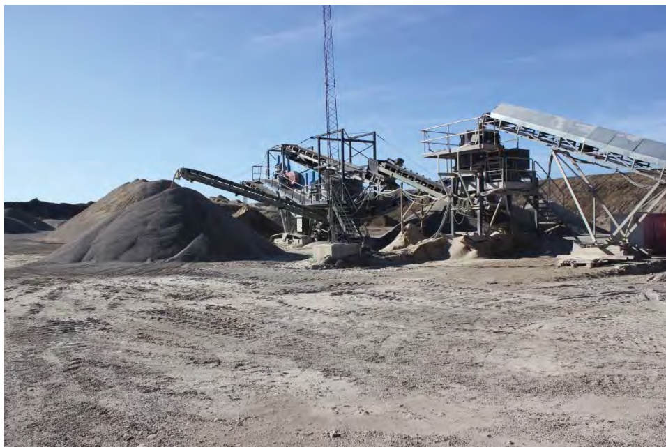
Figur 4.13: Oparbejdning af materialer sker nogle steder i større opstillinger med flere forbundne og stationære sorteringsanlæg og knusere, som vist her.
