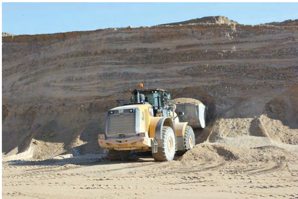
Figur 3.7: Indvindingen sker oftest med en frontlæsser fra foden af gravefronten.
