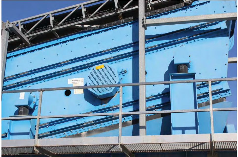
Figur 5.1: Binder Bivitec sigte type KRL/DD 1600 X5 m. gummisold og gummiophæng.
