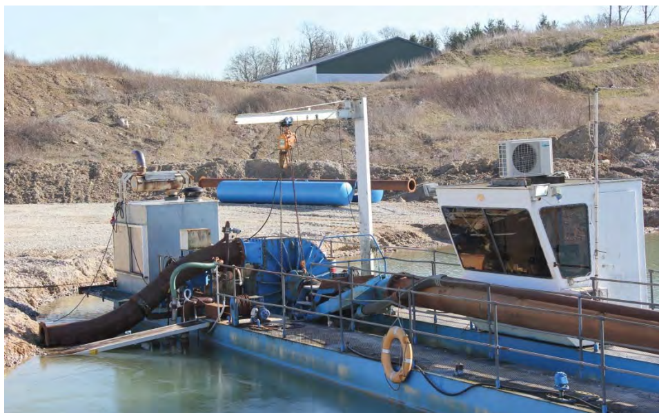
Figur 3.9: Indvinding under grundvandsspejl sker her med en suger, som kan flyttes omkring i gravesø.
