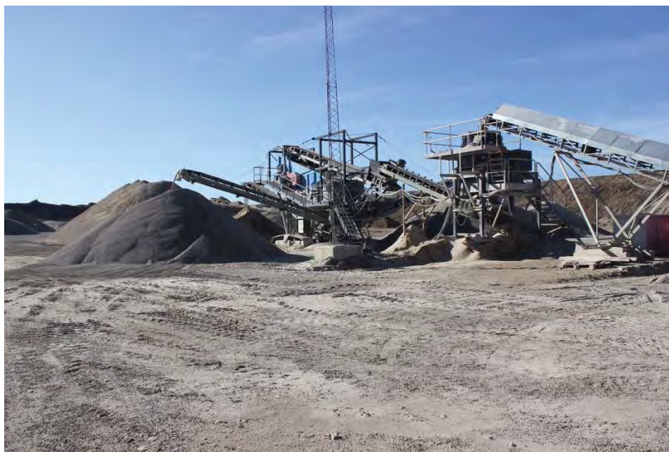
Figur 3.10: Bearbejdning af materialer sker nogle steder i større opstillinger med flere forbundne og stationære sorteringsanlæg og knusere.
