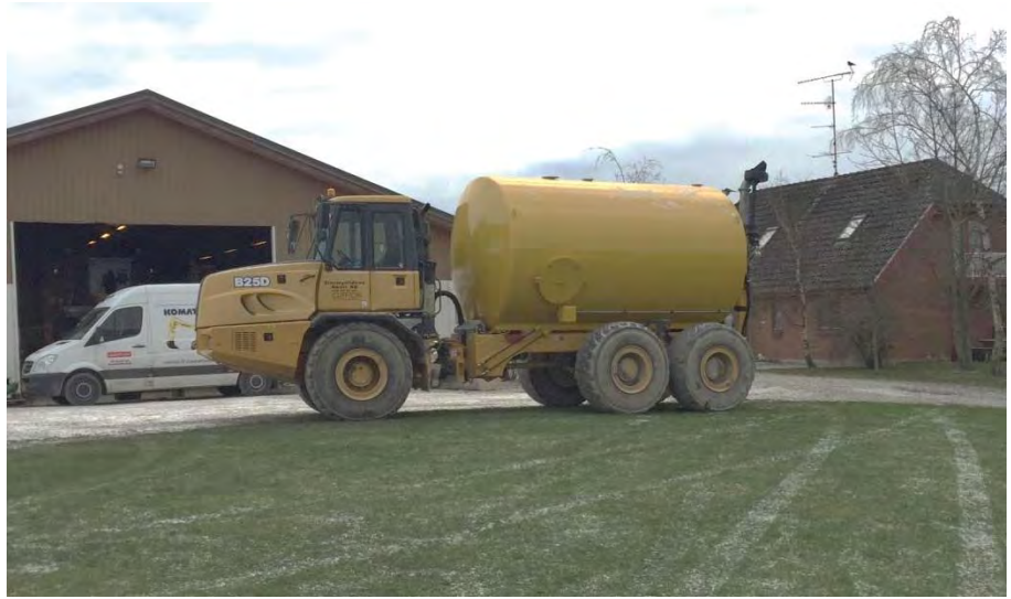
Figur 5.2: Ombygget Bell B25D-dumber som vandvogn.
