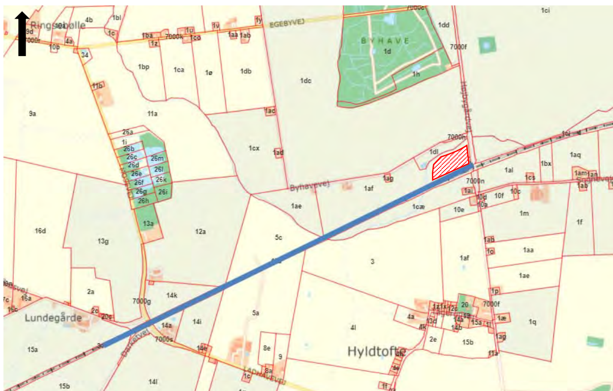
Figur 2. Kort over banestrækningen (markeret med blå streg). hvor dæmningsfyldet, der tilføres råstofgraven (markeret med rød) stammer fra.
